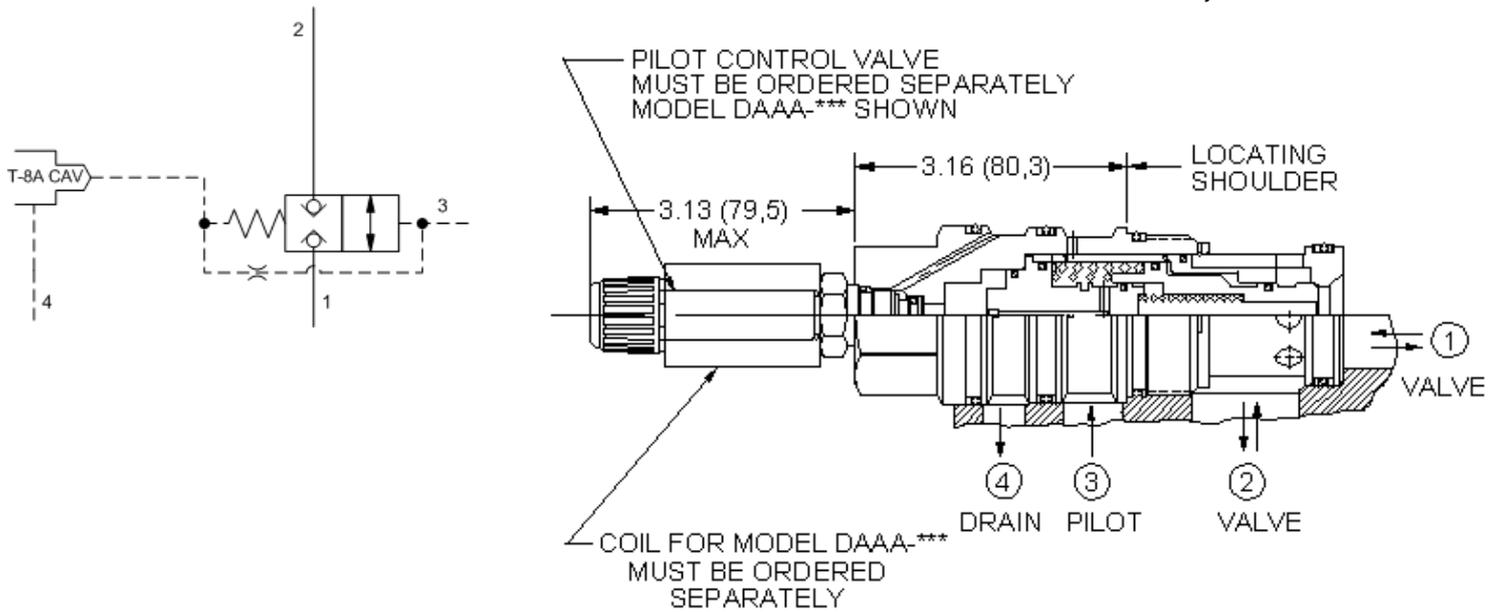
Dies ist ein in Ruhestellung geschlossenes Schaltelement in druckausgeglichener Sitzbauweise mit integrierter T-8A Einschraubbohrung. Wird in die T-8A-Bohrung ein 2/2-Wegeventil in gesperrter Stellung installiert, so bleibt der Ventilkolben geschlossen. Eine Öffnung des Wegeventils und ausreichender Steuerdruck an Anschluss 3 bewirken, dass der Kolben in die offene Ventilstellung geschaltet wird.
