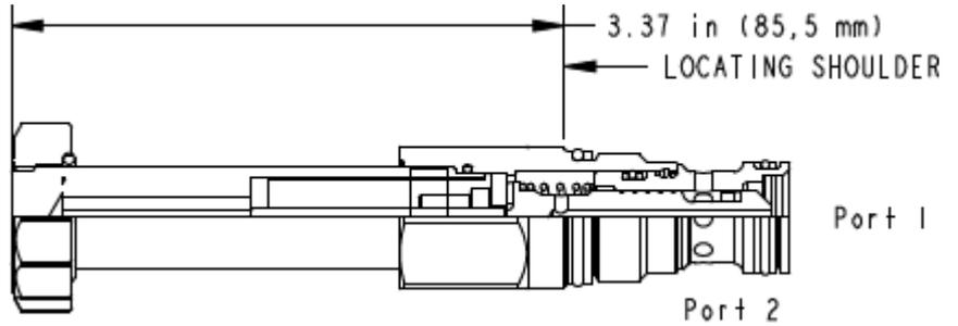
Das magnetbetätigte 2/2-Wegeventil ist ein direktgesteuertes Schieberventil. Das Ventil ist in offener oder geschlossener Ruhestellung erhältlich und kann mit den Spulen der Flex-Serie genutzt werden.
