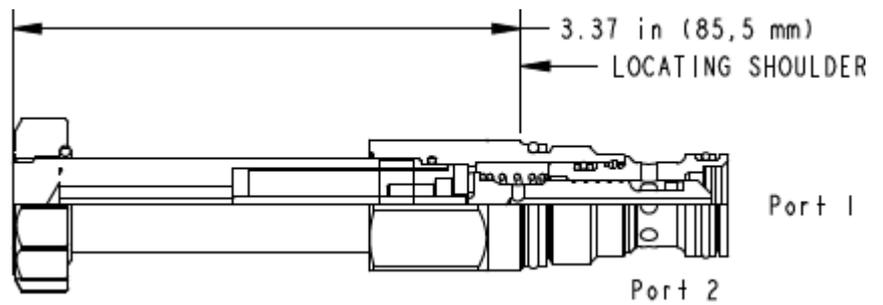
Das magnetbetätigte 2/2-Wegeventil ist ein direktgesteuertes Schieberventil. Das Ventil ist in offener oder geschlossener Ruhestellung erhältlich und kann mit den Spulen der Flex-Serie genutzt werden.
