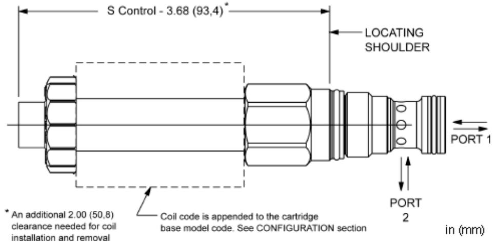
Diese magnetbetätigten 2/2-Wege-Ventile sind direkt wirkende Schieberventile mit Soft-Shift-Funktion. Mit Hilfe der Soft-Shift-Funktion können Druckstöße infolge der Ventilbetätigung reduziert werden. Die Ventile sind mit geschlossener und geöffneter Ruhestellung erhältlich. Die Ventile werden mit Spulen der Serien 740 und 747 betrieben.
