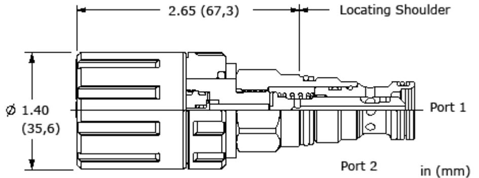
Dieses handbetätigten 2/2-Wegeventil mit druckausgeglichenem, direkt gesteuertem Schieber ist in unbetätigt offener oder geschlossener Ausführung erhältlich und wird benutzt, um die Richtung von Volumenströmen in hydraulischen Schaltungen zu bestimmen. Die Handbetätigung erfolgt über SUNs dreh- und rastbare Verstellvorrichtung. Diese Verstellung ist nicht für den Dauerbetrieb geeignet.
