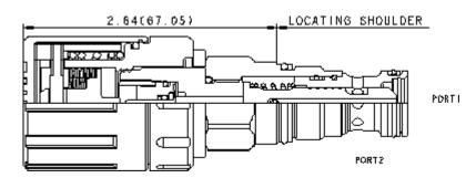
Dieses handbetätigten 2/2-Wegeventil mit druckausgeglichenem, direkt gesteuertem Schieber ist in unbetätigt offener oder geschlossener Ausführung erhältlich und wird benutzt, um die Richtung von Volumenströmen in hydraulischen Schaltungen zu bestimmen. Die Handbetätigung erfolgt über SUNs dreh- und rastbare Verstelleinrichtung. Diese Verstellung ist nicht für den Dauerbetrieb geeignet.
