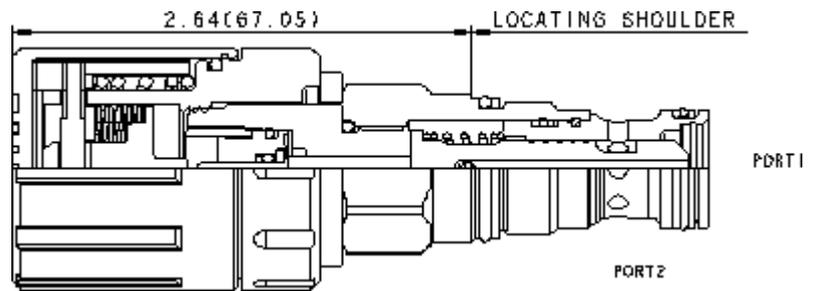
Ce distributeur en cartouche à 2 voies et 2 positions à commande manuelle est une valve à action directe à tiroir équilibré qui est utilisée pour diriger le débit dans un circuit hydraulique. Elle est disponible dans la version normalement ouverte ou normalement fermée. La valve est actionnée par la commande manuelle rotative Sun qui est conçue pour un usage occasionnel uniquement.
