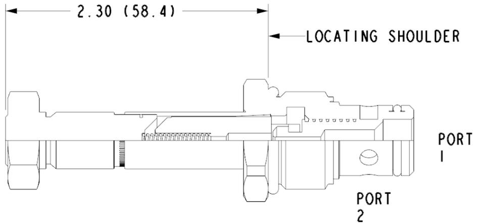
Das magnetbetätigte 2/2-Wegeventil ist ein direkt gesteuertes, druckausgeglichenes Schieberventil. Das Ventil ist nur mit geschlossener Ruhestellung erhältlich. Das Ventil wird mit einer Spule der 780er Serie gesteuert.
