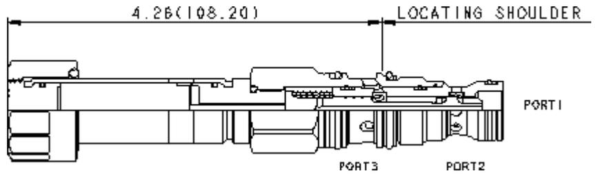
Dieses direkt gesteuerte 3/2-Wege-Magnetventil in druckausgeglicherer Schieberbauweise eignet sich als Wegeventil in hydraulischen Schaltungen.
