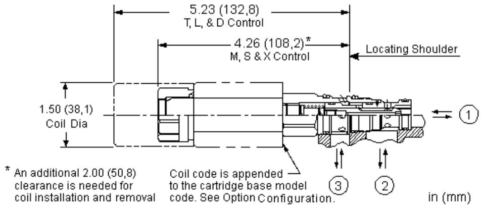
Dieses direkt gesteuerte 3/2-Wege-Magnetventil in druckausgeglichenen Schieberbauweise eignet sich als Wegeventil in hydraulischen Schaltungen.
