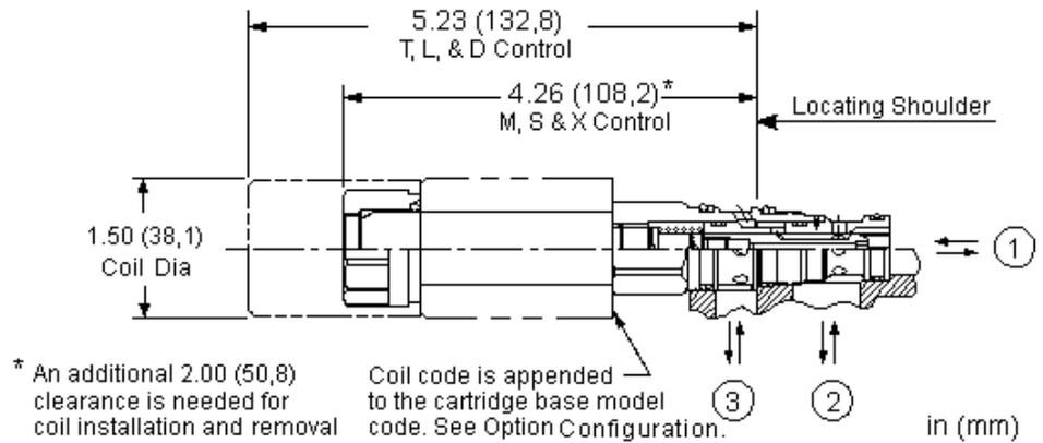
Dieses direkt gesteuerte 3/2-Wege-Magnetventil in druckausgeglichener Schieberbauweise eignet sich als Wegeventil in hydraulischen Schaltungen.
