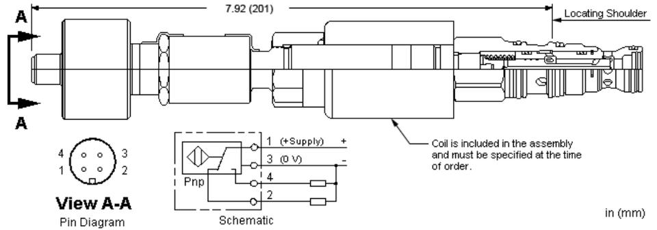
Cette électrovalve en cartouche 3 voies / 2 positions est un distributeur à action directe à tiroir équilibré. La transition entre les 2 positions est fermée. Elle permet de réduire les fuites durant la commutation du tiroir, ce qui peut s'avérer important dans les circuits de pilotage. Le détecteur de position qui confirme que la valve est en position de repos avec rappel par ressort.
