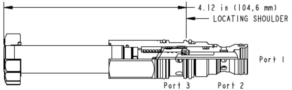
Dieses direkt gesteuerte 3/2-Wege-Magnetventil in druckausgeglichener Schieberbauweise eignet sich als Wegeventil in hydraulischen Schaltungen.
