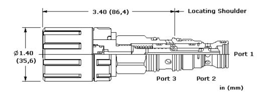
Dieses handbetätigte 3/2-Wegeventil mit druckausgeglichenem, direkt gesteuertem Schieber wird benutzt, um die Richtung von Volumenströmen in hydraulischen Schaltungen zu bestimmen. Die Handbetätigung erfolgt über SUNs dreh- und rastbare Verstelleinrichtung. Diese Verstellung ist nicht für den Dauerbetrieb geeignet.
