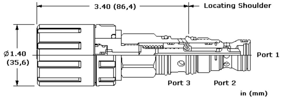
Dieses handbetätigte 3/2-Wegeventil mit druckausgeglichenem, direkt gesteuertem Schieber wird benutzt, um die Richtung von Volumenströmen in hydraulischen Schaltungen zu bestimmen. Die Handbetätigung erfolgt über SUNS dreh- und rastbare Verstellereinrichtung. Diese Verstellung ist nicht für den Dauerbetrieb geeignet.
