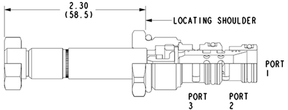
Das magnetbetätigte 3/2-Wegeventil ist ein direkt gesteuertes, druckausgeglichenes Schieberventil. Das Ventil wird mit einer Spule der 780er Serie gesteuert.
