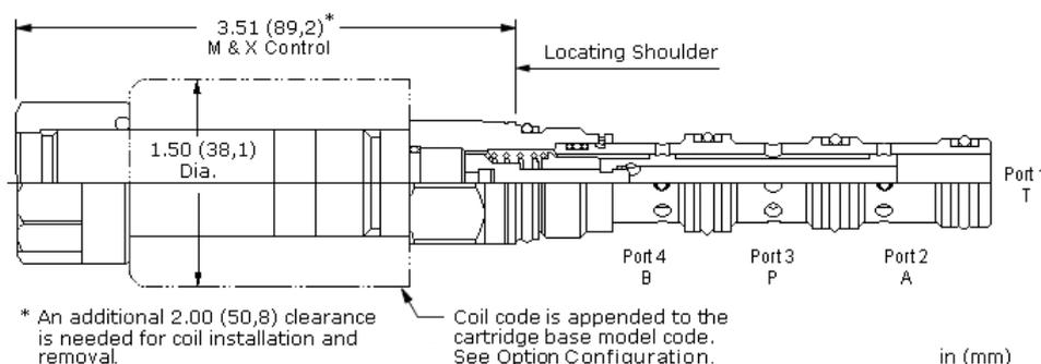
Cette électrovalve en cartouche 4 voies / 2 positions est un distributeur à action directe à tiroir équilibré. La transition entre les 2 positions est fermée. Elle permet de réduire les fuites durant la commutation du tiroir, ce qui peut s'avérer important dans les circuits de pilotage.
