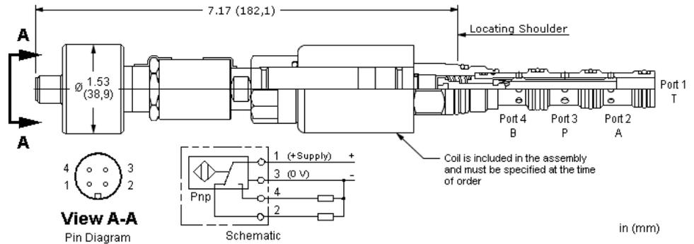
Dieses direkt gesteuerte 4/2-Wege-Magnetventil in druckausgeglichener Schieberbauweise eignet sich als Wegeventil in hydraulischen Schaltungen. Die positive Überdeckung während des Schaltübergangs reduziert den Ölverlust während des Schaltens, was in Vorsteuerschaltungen vorteilhaft sein kann. Das Ventil hat einen Positionsschalter, der eine Information darüber liefert, ob das Ventil unbetätigt ist.
