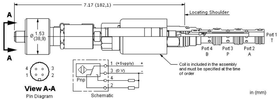
Cette électrovalve en cartouche 4 voies / 2 positions est un distributeur à action directe à tiroir équilibré. La transition entre les 2 positions est fermée. Elle permet de réduire les fuites durant la commutation du tiroir, ce qui peut s'avérer important dans les circuits de pilotage. Le détecteur de position qui confirme que la valve est en position de repos avec rappel par ressort.
