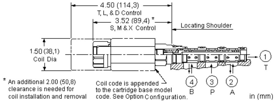
Dieses 4/2-Wege-Magnetventil ist ein direkt gesteuertes, weichschaltendes Ventil in druckausgeglichener Schieberbauweise. Die weichschaltende Arbeitsweise vermindert beim Schaltvorgang wirksam die Druckstöße im System.
