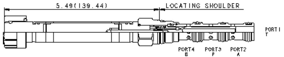
Cet électrodistributeur en cartouche 4 voies / 3 positions à action directe a un rappel du tiroir par ressort en position neutre. Lorsque la bobine A est excitée, le débit passe de l'orifice 3 (P) vers l'orifice 2 (A) et de l'orifice 4 (B) vers l'orifice 1 (T). Lorsque la bobine B est excitée, le débit passe de l'orifice 3 (P) vers l'orifice 4 (B) et de l'orifice 2 (A) vers l'orifice 1 (T).
