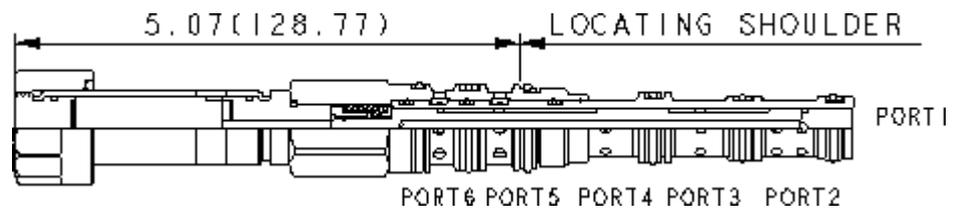
Dieses 6/2-Wege-Magnetventil ist ein direkt gesteuertes, druckausgeglichenes Ventil in Schieberbauweise. Das Ventil wird typischerweise für die Wahl zwischen zwei separaten Kreisläufen verwendet. Bei unbestromter Magnetspule werden P und T mit dem ersten Kreislauf verbunden. Nach dem Schalten sind P und T mit dem zweiten Kreislauf verbunden.
