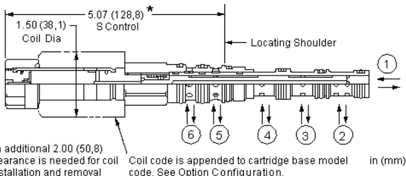
Cet électrodistributeur en cartouche 6 voies / 2 positions à commutation amortie est une valve à action directe à tiroir équilibré. L'amortissement permet de réduire les pics de pression lors des commutations. Il permet d'alimenter alternativement 2 circuits séparés. Lorsque la bobine n'est pas excitée, le débit passe des orifices P et T vers le premier circuit et lorsqu'elle est excitée, le débit passe des orifices P et T vers le deuxième circuit.
