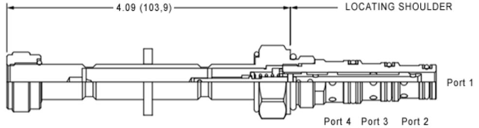
Das direkt wirkende, magnetbetätigte 4/3-Wege-Schieberventil hat eine federzentrierte Mittelstellung. Wenn Spule A bestromt wird, erfolgt der Durchfluss von Anschluss 3 (P) zu Anschluss 2 (B) und von Anschluss 4 (A) zu Anschluss 1 (T). Wenn Spule B bestromt wird, erfolgt der Durchfluss von Anschluss 3 nach Anschluss 4 und von Anschluss 2 nach Anschluss 1.
