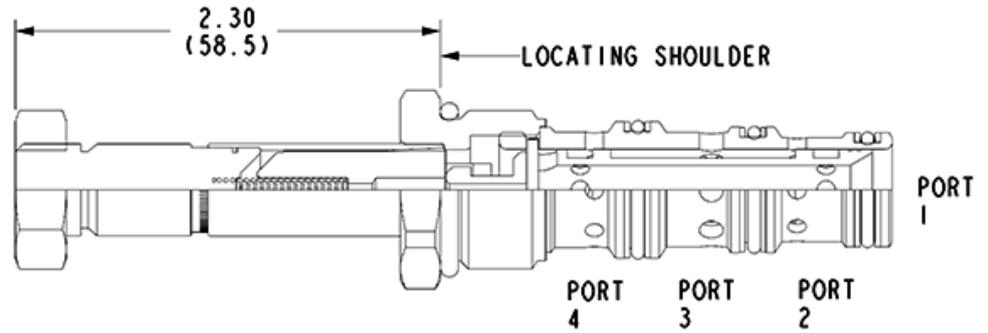
Das magnetbetätigte 4/2-Wegeventil ist ein direkt gesteuertes, druckausgeglichenes Schieberventil. Das Ventil wird mit einer Spule der 780er Serie gesteuert.
