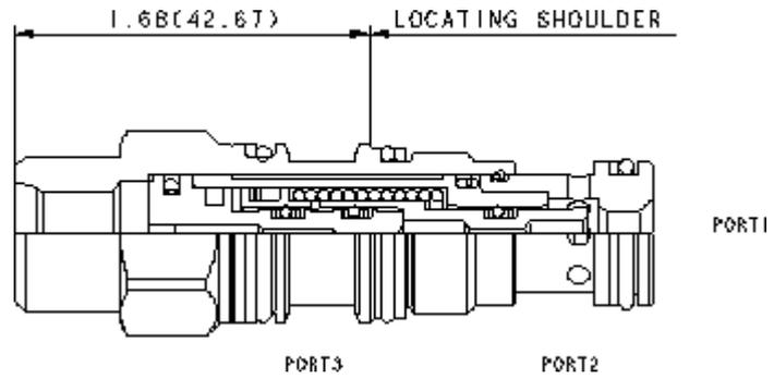
Les éléments logiques à 3 chambres, normalement ouverts, à action directe, sont des valves à clapet hydrauliquement équilibrées entre les chambres 1 et 2. Le ressort principal maintient la valve ouverte et lorsqu'une pression de pilotage est appliquée à la chambre 3 la valve commute à la position fermée.
