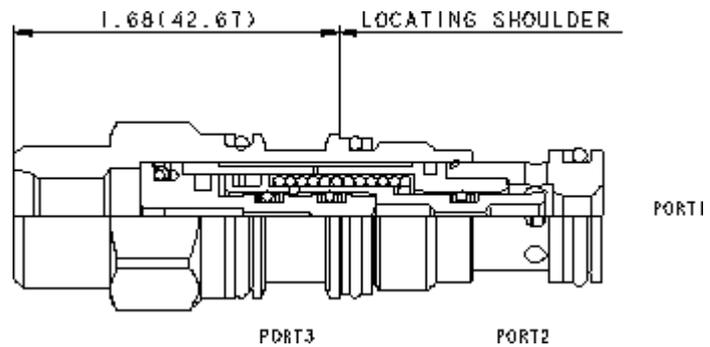
Dies ist ein in Ruhestellung offenes Schaltelement in druckausgeglichener Sitzbauweise. Bei gesperrtem externen Entlastungsanschluss bleibt der Ventilkolben in der offenen Stellung. Das Ventil schließt, wenn der externe Anschluss entlastet wird und ausreichender Steuerdruck an Anschluss 3 anliegt.
