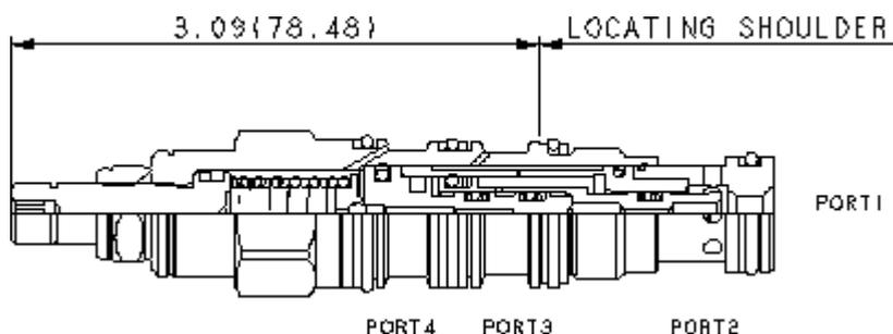
Les éléments logiques normalement ouverts qui commutent quand on les pilote et dont la pression pilote est réglable sont des valves à clapet hydrauliquement équilibrées entre les chambres 1 et 2. Le ressort principal maintient la valve ouverte jusqu'à ce que la pression pilote, qui est réglée sur l'étage pilote intégré et appliquée à l'orifice 3, soit atteinte. A cet instant la valve commute à la position fermée.
