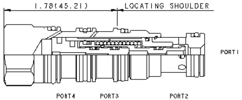
Dies ist ein in Ruhestellung offenes Schaltelement in druckausgeglichener Sitzbauweise. Bei gesperrtem Entlastungsanschluss 4 bleibt der Kolben in der offenen Stellung. Das Ventil schließt, wenn Anschluss 4 entlastet wird und ausreichender Steuerdruck an Anschluss 3 anliegt.
