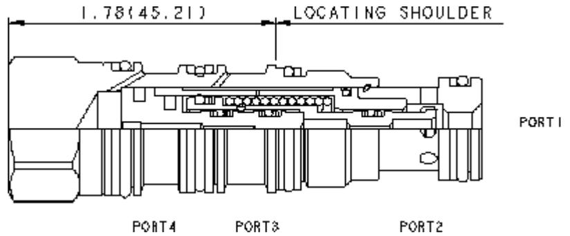
Les éléments logiques normalement ouverts qui commutent quand on libère le drain sont des valves à clapet hydrauliquement équilibrées entre les chambres 1 et 2. Le ressort principal maintient la valve ouverte. Quand une pression de pilotage est appliquée alors que le drain est bloqué (chambre 4) la valve reste dans la position ouverte. Lorsque le drain est libéré, cela déséquilibre le clapet et la valve commute à la position fermée.
