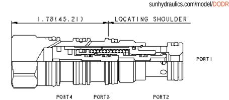
Les éléments logiques normalement ouverts qui commutent quand on libère le drain sont des valves à clapet hydrauliquement équilibrées entre les chambres 1 et 2. Le ressort principal maintient la valve ouverte. Quand une pression de pilotage est appliquée alors que le drain est bloqué (chambre 4) la valve reste dans la position ouverte. Lorsque le drain est libéré, cela déséquilibre le clapet et la valve commute à la position fermée.
