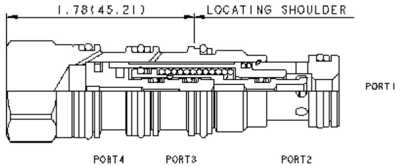
Dies ist ein in Ruhestellung offenes Schaltelement in druckausgeglichener Sitzbauweise. Steuerdruck an Anschluss 3 schaltet das Ventil in die geschlossene Stellung.
