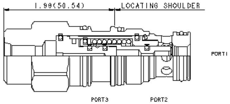
Dies ist ein in Ruhestellung offenes Schaltelement in druckausgeglichener Sitzbauweise. Steuerdruck an Anschluss 3 schaltet das Ventil in die geschlossene Stellung.
