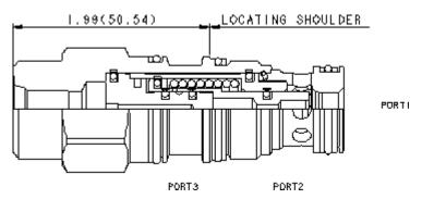
Les éléments logiques à 3 chambres, normalement ouverts, à action directe, sont des valves à clapet hydrauliquement équilibrées entre les chambres 1 et 2. Le ressort principal maintient la valve ouverte et lorsqu'une pression de pilotage est appliquée à la chambre 3 la valve commute à la position fermée.
