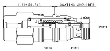
Dies ist ein in Ruhestellung offenes Schaltelement in druckausgeglichener Sitzbauweise. Steuerdruck an Anschluss 3 schaltet das Ventil in die geschlossene Stellung.
