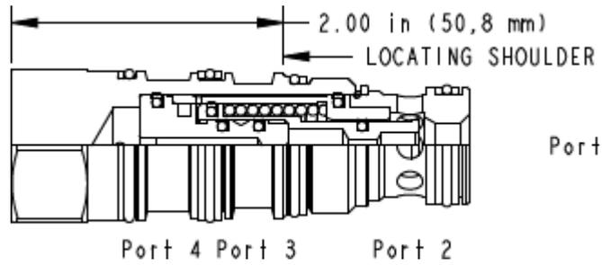
Les éléments logiques normalement ouverts qui commutent quand on libère le drain sont des valves à clapet hydrauliquement équilibrées entre les chambres 1 et 2. Le ressort principal maintient la valve ouverte. Quand une pression de pilotage est appliquée alors que le drain est bloqué (chambre 4) la valve reste dans la position ouverte. Lorsque le drain est libéré, cela déséquilibre le clapet et la valve commute à la position fermée.
