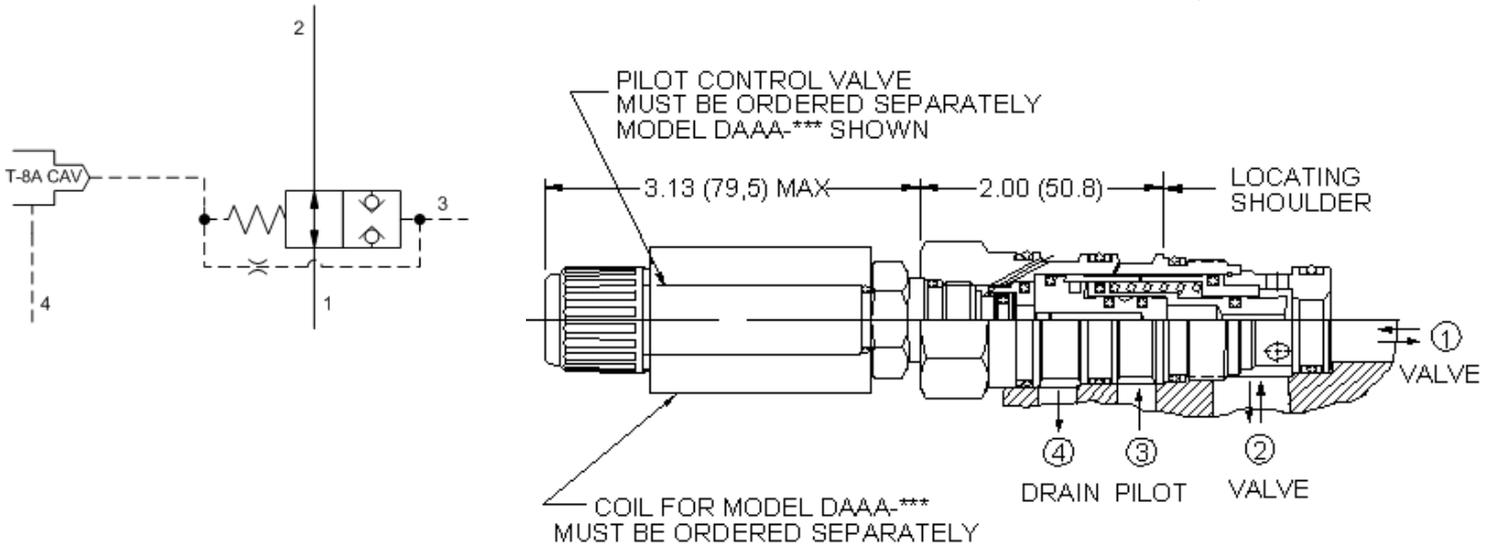
Dies ist ein in Ruhestellung offenes Schaltelement in druckausgeglichener Sitzbauweise mit integrierter T-8A Einschraubbohrung. Wird in die T-8A-Bohrung ein 2/2-Wegeventil in gesperrter Stellung installiert, so bleibt der Ventilkolben offen. Eine Öffnung des Wegeventils und ausreichender Steuerdruck an Anschluss 3 bewirken, dass der Kolben in die geschlossene Ventilstellung geschaltet wird.
