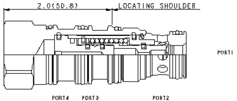
Dies ist ein in Ruhestellung offenes Schaltelement in druckausgeglichener Sitzbauweise. Steuerdruck an Anschluss 3 schaltet das Ventil in die geschlossene Stellung.
