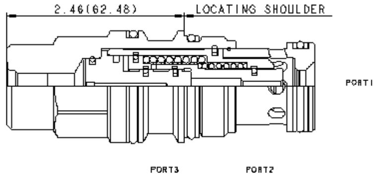
Dies ist ein in Ruhestellung offenes Schaltelement in druckausgeglichener Sitzbauweise. Bei gesperrtem externen Entlastungsanschluss bleibt der Ventilkolben in der offenen Stellung. Das Ventil schließt, wenn der externe Anschluss entlastet wird und ausreichender Steuerdruck an Anschluss 3 anliegt.
