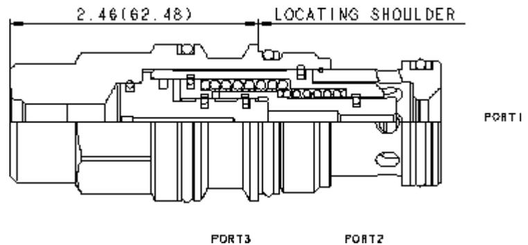
Les éléments logiques à 3 chambres, normalement ouverts, qui commutent quand on libère le drain sont des valves à clapet hydrauliquement équilibrées entre les chambres 1 et 2. Le ressort principal maintient la valve ouverte et lorsqu'une pression de pilotage est appliquée alors que l'orifice externe du drain est bloqué, la valve reste ouverte. Lorsque l'orifice externe du drain est libéré, cela déséquilibre le clapet et la valve commute à la position fermée.
