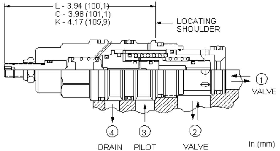
Dies ist ein in Ruhestellung offenes Schaltelement in druckausgeglichener Sitzbauweise. Bei Steuerdruck an Anschluss 3 bleibt das Ventil zunächst offen. Übersteigt der Steuerdruck den Einstellwert der internen Druckbegrenzung, so schaltet das Ventil in die geschlossene Stellung.
