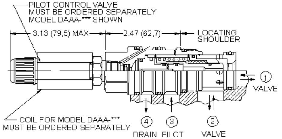
Dies ist ein in Ruhestellung offenes Schaltelement in druckausgeglichener Sitzbauweise mit integrierter T-8A Einschraubbohrung. Wird in die T-8A-Bohrung ein 2/2-Wegeventil in gesperrter Stellung installiert, so bleibt der Ventilkolben offen. Eine Öffnung des Wegeventils und ausreichender Steuerdruck an Anschluss 3 bewirken, dass der Kolben in die geschlossene Ventilstellung geschaltet wird.
