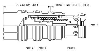
Dies ist ein in Ruhestellung offenes Schaltelement in druckausgeglichener Sitzbauweise. Steuerdruck an Anschluss 3 schaltet das Ventil in die geschlossene Stellung.
