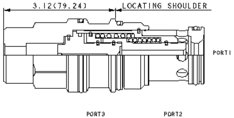
Dies ist ein in Ruhestellung offenes Schaltelement in druckausgeglichener Sitzbauweise. Steuerdruck an Anschluss 3 schaltet das Ventil in die geschlossene Stellung.
