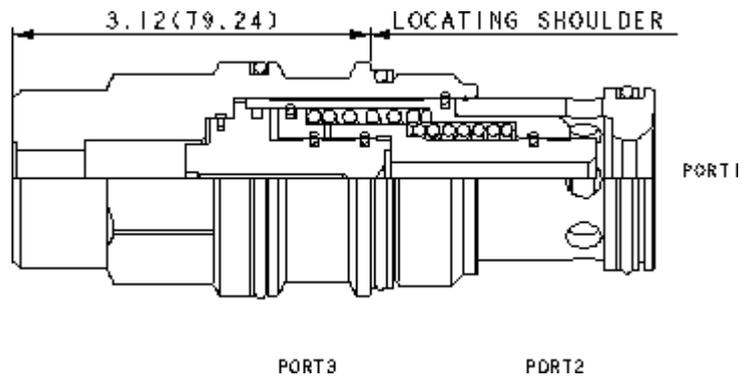
Les éléments logiques à 3 chambres, normalement ouverts, qui commutent quand on libère le drain sont des valves à clapet hydrauliquement équilibrées entre les chambres 1 et 2. Le ressort principal maintient la valve ouverte et lorsqu'une pression de pilotage est appliquée alors que l'orifice externe du drain est bloqué, la valve reste ouverte. Lorsque l'orifice externe du drain est libéré, cela déséquilibre le clapet et la valve commute à la position fermée.
