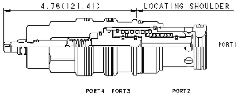
Dies ist ein in Ruhestellung offenes Schaltelement in druckausgeglichener Sitzbauweise. Bei Steuerdruck an Anschluss 3 bleibt das Ventil zunächst offen. Übersteigt der Steuerdruck den Einstellwert der internen Druckbegrenzung, so schaltet das Ventil in die geschlossene Stellung.
