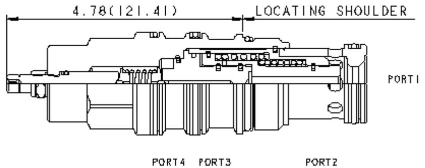
Les éléments logiques normalement ouverts qui commutent quand on les pilote et dont la pression pilote est réglable sont des valves à clapet hydrauliquement équilibrées entre les chambres 1 et 2. Le ressort principal maintient la valve ouverte jusqu'à ce que la pression pilote, qui est réglée sur l'étage pilote intégré et appliquée à l'orifice 3, soit atteinte. A cet instant la valve commute à la position fermée.
