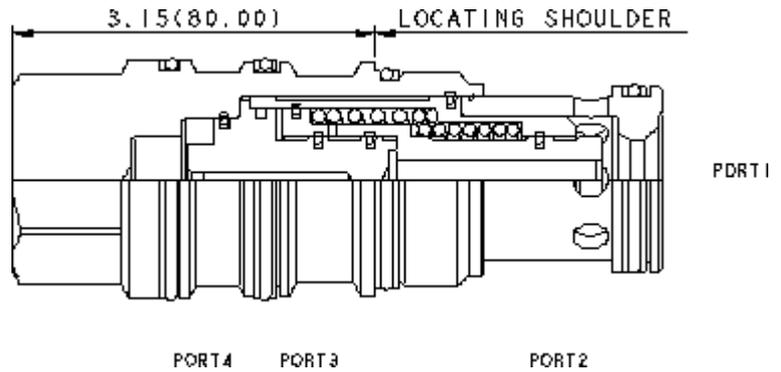
Les éléments logiques normalement ouverts qui commutent quand on libère le drain sont des valves à clapet hydrauliquement équilibrées entre les chambres 1 et 2. Le ressort principal maintient la valve ouverte. Quand une pression de pilotage est appliquée alors que le drain est bloqué (chambre 4) la valve reste dans la position ouverte. Lorsque le drain est libéré, cela déséquilibre le clapet et la valve commute à la position fermée.
