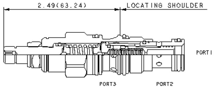
2/2-Wegeventil, vorgesteuert, mit geöffneter Ruhestellung für Schaltkreise mit kleinen Volumenströmen. Das Ventil kann den Ölstrom direkt steuern oder als Vorsteuerventil eine Hauptstufe betätigen. Es schaltet, sobald die Druckdifferenz zwischen Anschluss 1 und 3 größer ist als der Einstellwert.
