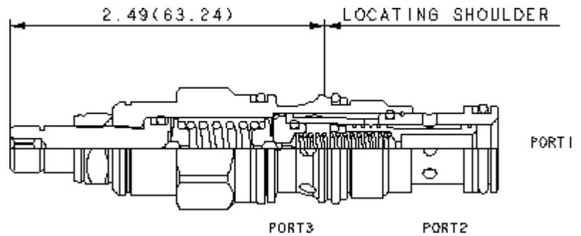
2/2-Wegeventil, vorgesteuert, mit geschlossener Ausgangsstellung, für Schaltkreise mit kleinen Volumenströmen. Das Ventil kann den Ölstrom direkt steuern oder als Vorsteuerventil eine Hauptstufe betätigen. Es schaltet, sobald die Druckdifferenz zwischen Anschluss 1 und 3 größer ist als der Einstellwert.
